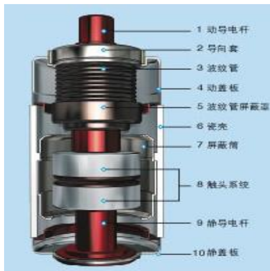
图 1 真空灭弧室结构图
